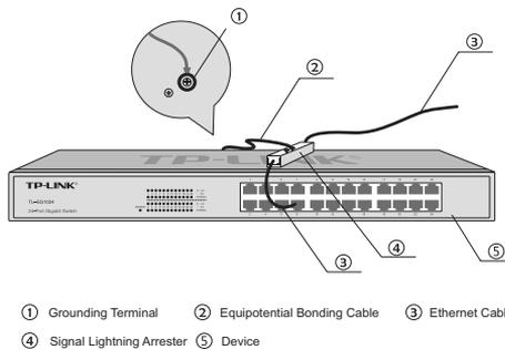
Figure 3-4 Equipotential Bonding
