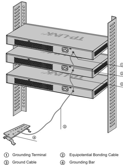
Figure 3-3 Equipotential Bonding
