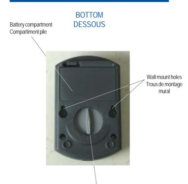
12 Position rotary commutator for handset connection matching Commutateur 12 positions pour adaptation des connections du combiné
